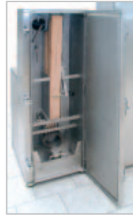
Friction smoke generator / Reibrauch-Erzeuger
