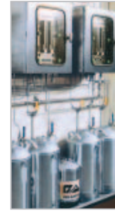
Liquid smoke applicator / Flüssigraucher- zeuger
